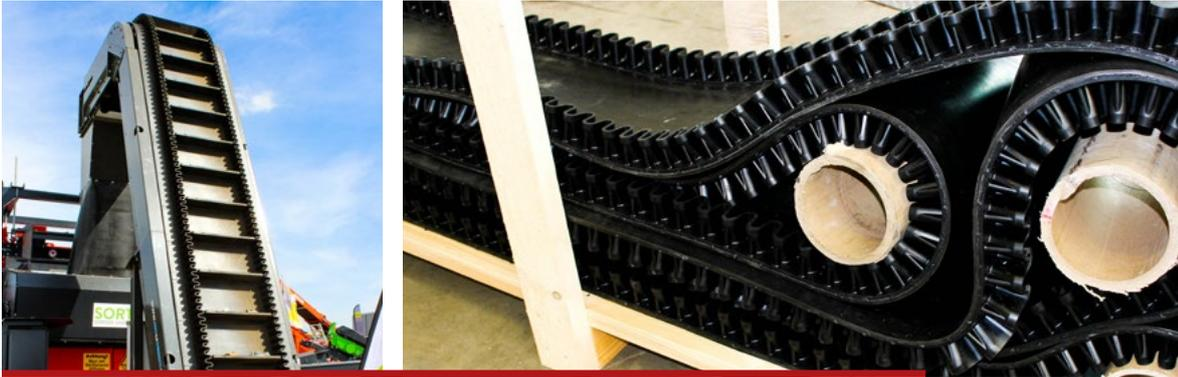
Stollen- und Wellkantengurte eignen sich hervorragend für stark ansteigende Förderstrecken. Zudem lassen sich die Stollen im Kaltklebverfahren aufbringen oder homogen heiß in die Deckplatte aufvulkanisieren.
